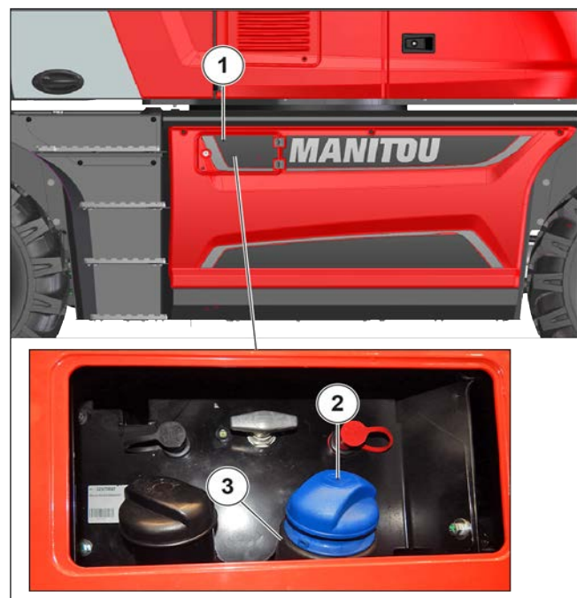
Figure 149: Vérification du niveau de liquide DEF
