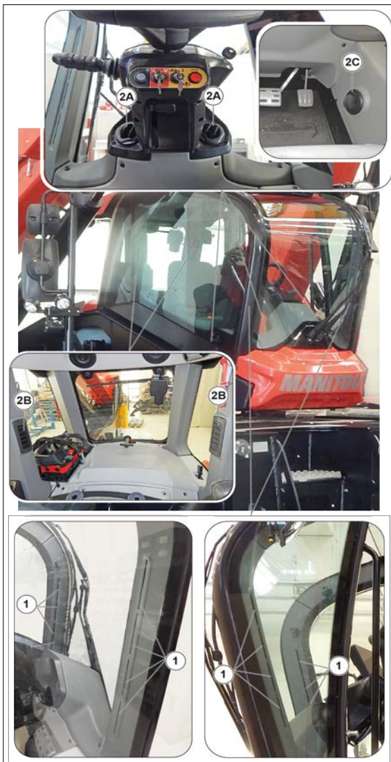
Figure 62: Diffuseurs de désembuage et bouches d'aération du chauffage
